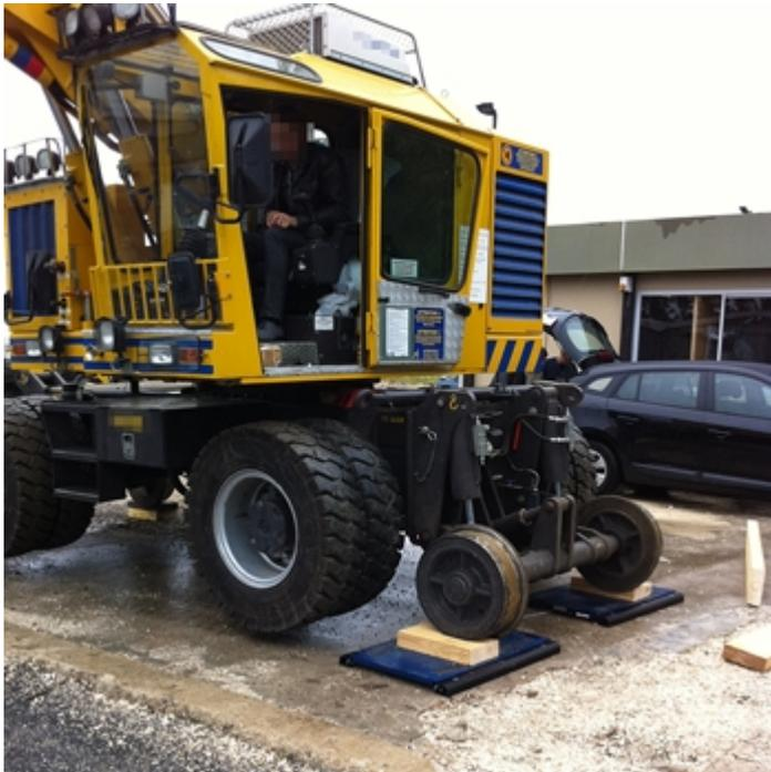
Esempi e installazioni di piattaforme pesa assi e ruote portatili
