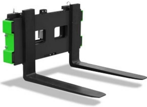
Piastra di pesatura per carrello elevatore con guida di fissaggio DIN15173 - FEM classe II, per trasformare un normale carrello in una bilancia elettronica mobile. Disponibili anche in versione OMOLOGATA CE-M. Opzione Memory Card disponibile per memorizzare i dati di ogni pesata.
