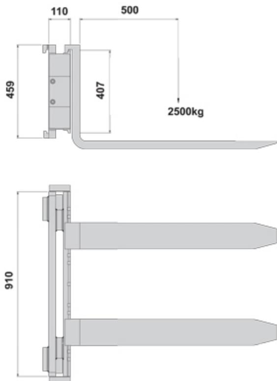
Dimensioni in mm della piastra di pesatura.
